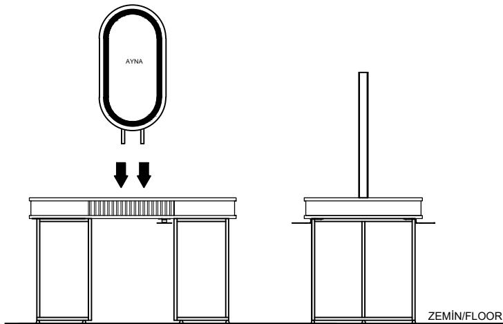
Ayna üzerinde bulunan M8 bağlantı milini tezgahın delik konumundan geçip civata ile montajını yapınız.
