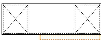
Dolap modülü, çerçeve modülünde bulunan yuvaya oturulup 3.5x30 vida ile sıkılır. Elektrik bağlantıları yapılip montaj tamamlanır.
